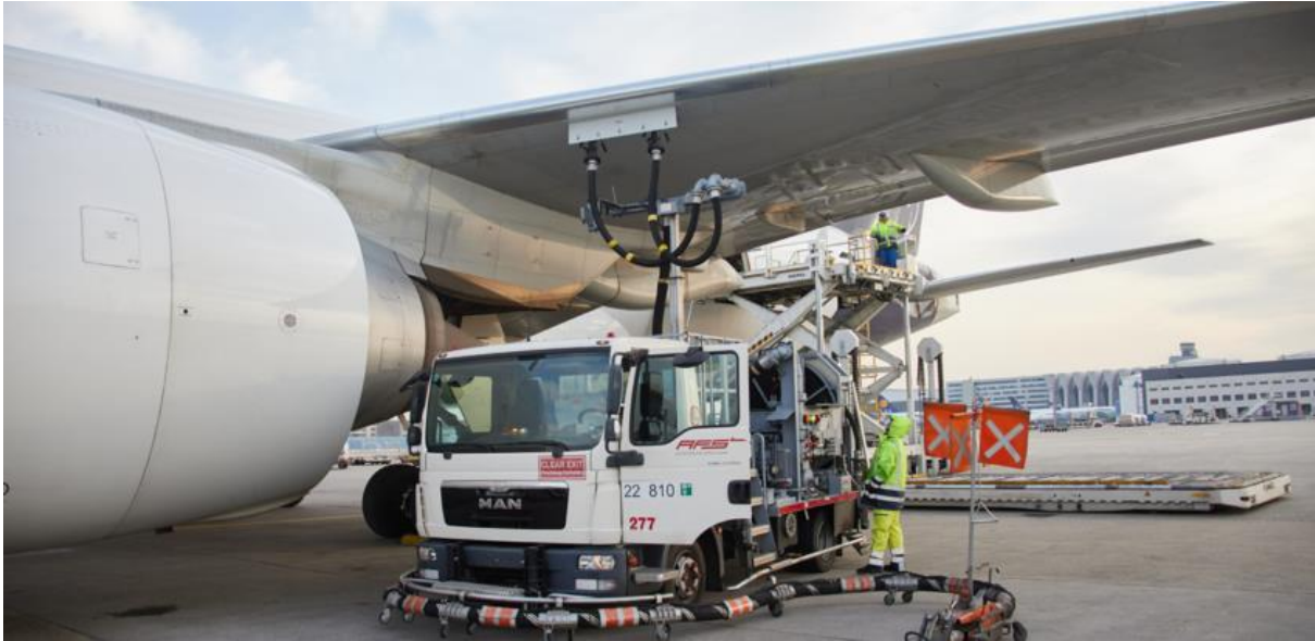
Betankung des Flugzeugs in Frankfurt: das SAF wird über das Tanksystem des Flughafens dem herkömmlichen Kerosin beigemischt ©Lufthansa Cargo/Oliver Rösler 01.04.2021
